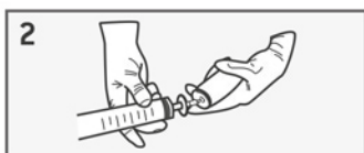
innestare l'assieme siringa-filtro sull'adattatore montato sulla bomboletta
