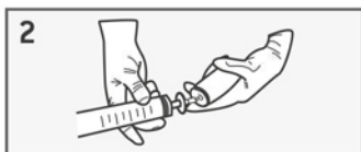
innestare l'assieme siringa-filtro sull'adattatore montato sulla bomboletta
