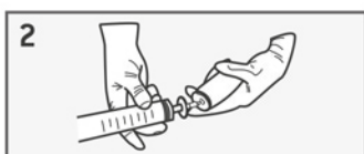
2 innestare l'assieme siringa-filtro sull'adattatore montato sulla bomboletta
