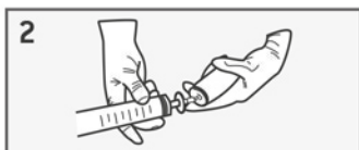
2 innestare l'assieme siringa-filtro sull'adattatore montato sulla bomboletta
