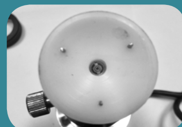
D) led ad alta luminosità (per l'illuminazione del fondo dell'occhio)
