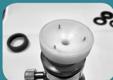
C) alloggiamento del bulbo oculare, in teflon
