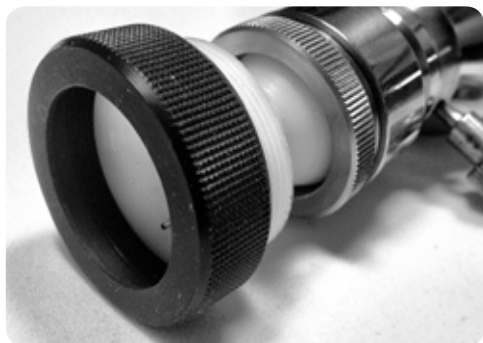
A) ghiera in teflon per il fissaggio superiore del bulbo oculare
